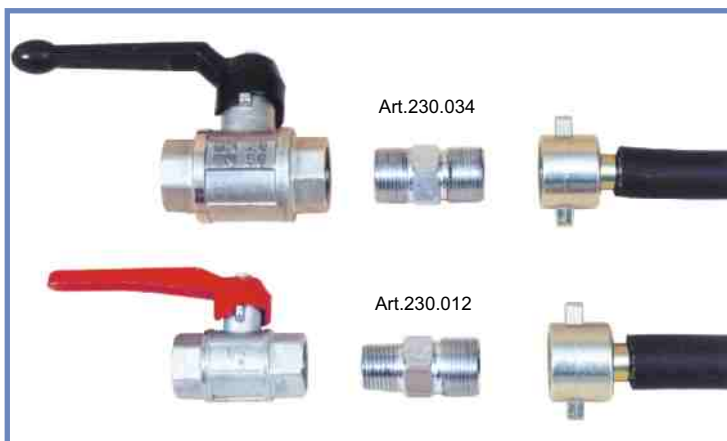
Esempio di connessione con raccordi serie 200 di tubi flessibili con rubinetti a sfera tramite i nipples adattatori Art.230.034 e Art.230.012.
