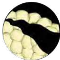
Frattura abrasivo Sol-Gel / Sol-Gel abrasive fracture
