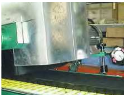
Pulizia del prestampato / Precured tread cleaning
