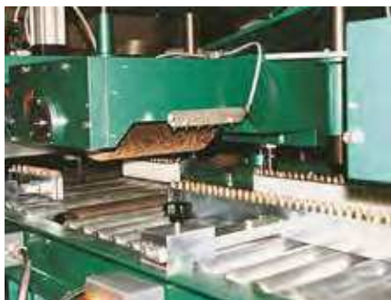
Raspatura del prestampato / Precured tread buffing
