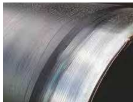
Testata dopo il trattamento di spazzolatura / Pipe chamfer properly brushed
