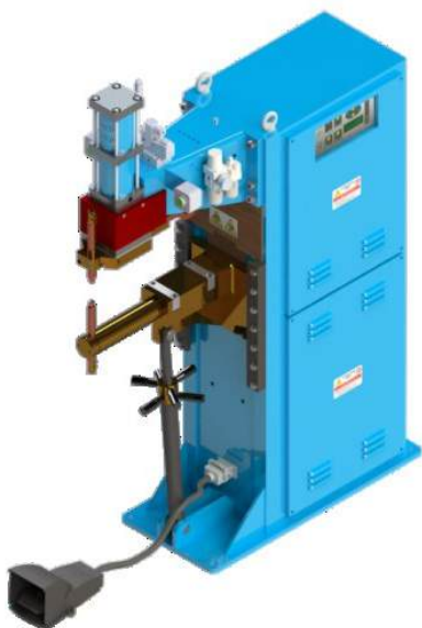
PUNTATRICE A COLONNA serie SD120 a discesa rettilinea con potenza di 120KVA al 50%
